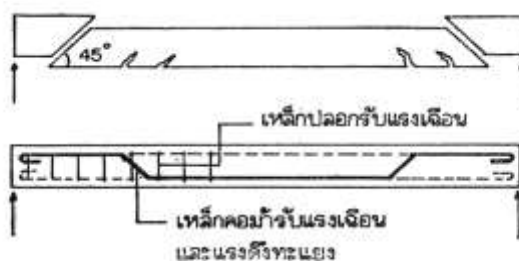
ภาพแสดง แรงเฉือนและแรงดัดที่กระทำในคาน
