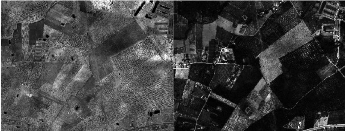
รูปที่ 3 ภาพถ่ายจากอากาศยานไร้คนขับในช่วงคลื่นอินฟราเรดใกล้ (NIR band) และในช่วงคลื่นแสงสีแดง (Red band)
